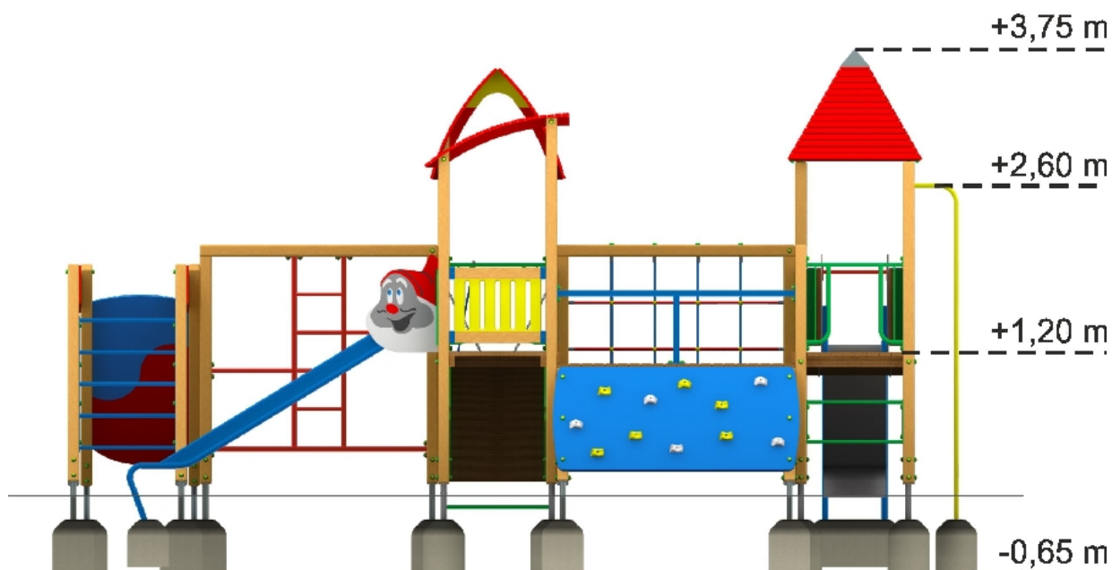
Rys. 3 Zestaw zabawowy duży (widok z boku - z wysokościami).
